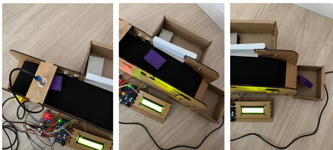
Figura 18. Detecção e separação de objetos não metálicos.
